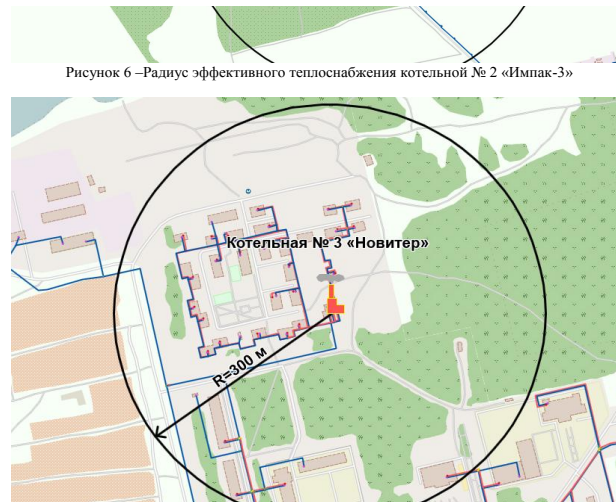
Рисунок 7 – Радиус эффективного теплоснабжения котельной № 3 «Новитер»
